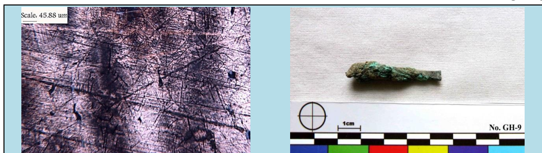
تصویر ۵- ریزساختار میکروسکوپی نوری از مغز فلزی نمونه شماره ۹ با ساختار به‌شدت چکش‌کاری شده با دانه‌های درهم و تغییر شکل یافته و همچنین خطوط لغزشی فراوان (محلول اچ: کلروفریک آبی)
