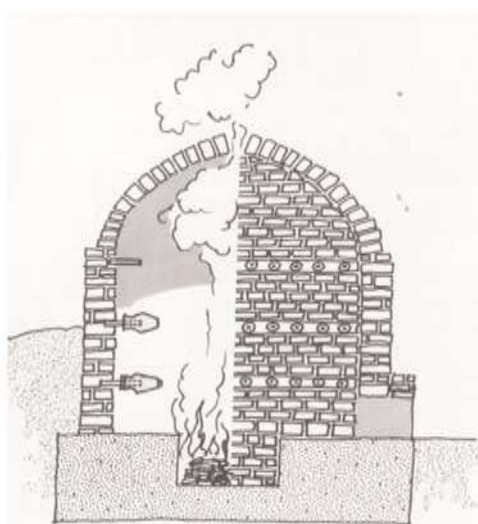
طرح ۲: بازسازی کوره‌های شوش (سمت چپ) و نیشابور (سمت راست تصویر) (برگرفته از Soustiel, 1985)
