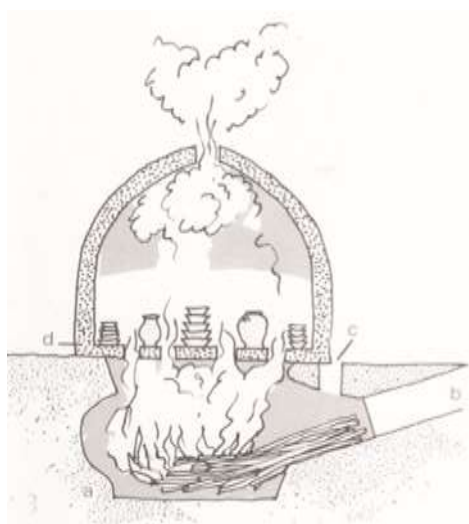
طرح ۲: بازسازی کوره‌های شوش (سمت چپ) و نیشابور (سمت راست تصویر) (برگرفته از Soustiel, 1985)
