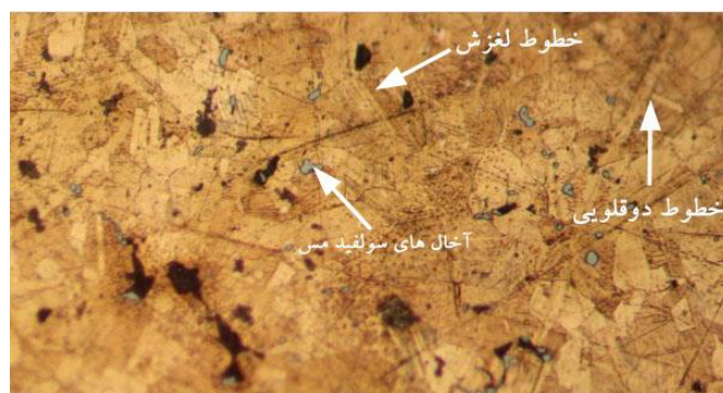
شکل ۴- بزرگ‌نمایی ۲۰۰ برابر مقطع عرضی اچ‌شده الگوی J-A-2010-29، وجود خطوط دوقلوبی، خطوط لغزش و آخال‌های سولفید مس در ریزساختار
